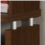
Опоры приставных столов – металлические, рифленые, D80 мм | Опори приставних столів – металеві, рифлені, D80 мм | Legs of additional desks – corrugated metal, D80 mm (регулировка: 15 мм | регулювання: 15 mm | adjustment: 15 mm)
